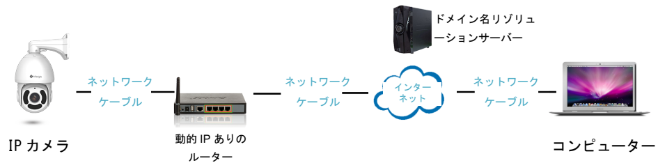
図 2-2 動的 IP を使用したルーター経由でネットワークカメラを接続
